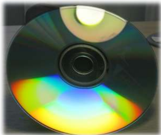
Дифракция на поверхности не записанного CD диска
