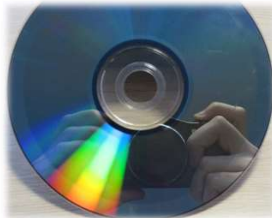
Дифракция на поверхности записанного CD диска
